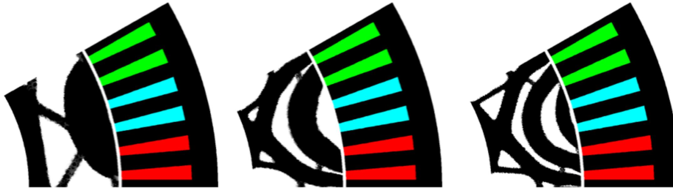
TC et. al. (2024) "Optimisation topologique magnéto-mécanique d'un rotor de machine électrique synchro-réductante. "
